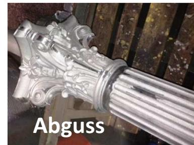
Projekt: Guss säule für Balkonunterbau – Länge ca. 4m, Gewicht ca. 300kg
